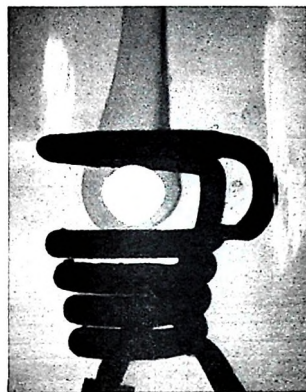
Bild 5 (links). Levitation einer frei schwebenden Wolframkugel von 7 mm \varnothing bei etwa 2600 °K. Bild 6 (rechts). Levitation einer frei schwebenden, von einer Kupferdampfhülle umgebenen flüssigen Kupferprobe von 7,5 mm \varnothing bei etwa 1500 °K
